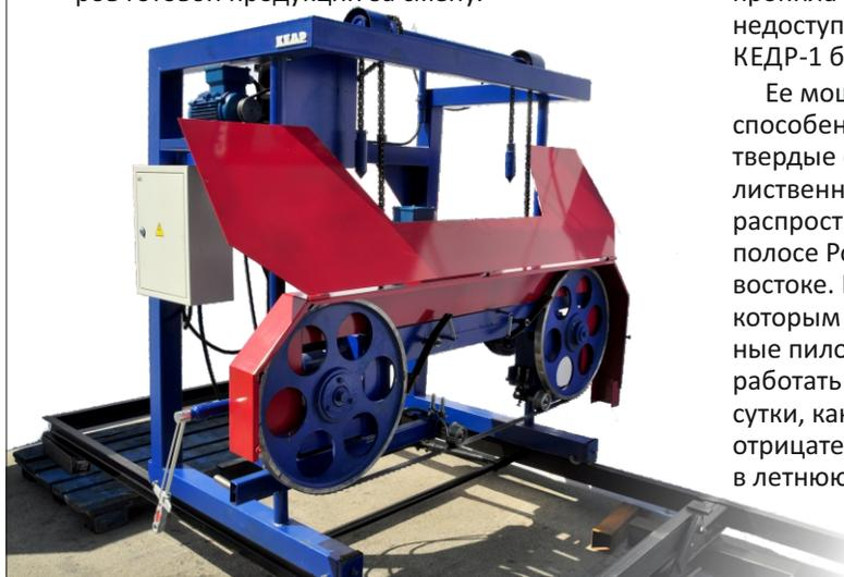
Данный ленточнопильный станок оснащен электромеханической системой подъема пилы, что делает позиционирование пильной каретки простым и быстрым, позволяя регулировать положение пропила с эффективностью, недоступной моделям КЕДР и КЕДР-1 без электроподъемника.
