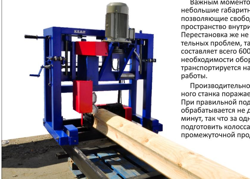
Важным моментом являются небольшие габаритные размеры, позволяющие свободно организовать пространство внутри мастерской. Перестановка же не создает дополнительных проблем, так как вес станка составляет всего 600 кг. Так что при необходимости оборудование легко транспортируется на новое место работы.
