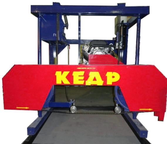
Ленточная пила типа «КЕДР-Гибрид» может работать как от электросети, так и на бензиновом четырехтактном двигателе. Такая особенность конструкции является универсальной и позволяет поддерживать бесперебойную работу оборудования в различных условиях. «КЕДР-Гибрид» идеально подойдет для нужд производства, которое размещено в регионе с ограниченной подачей электроэнергии. Надежность оборудования подтверждает тот факт, что оно может работать даже при отрицательной температуре воздуха.
